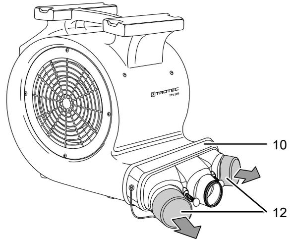
5. Schließen Sie geeignete Schläuche (13) an den Dreifach-Schlauchverteiler (10) an und befestigen Sie diese mit einer geeigneten Schlauchschelle (14).
